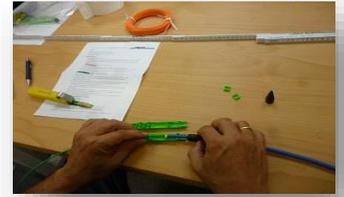
8. Einzelne Glasfasern in vorbereitete Simplexschutzschläuche einführen und im Aufteiler gleichmäßig symmetrisch einlegen; 900µ Innenröhrchen durch den Kamm im Grundkörper stecken und zurückgeschlagenen Kevlar unter die Simplexadern klemmen. Zur verbesserten Zugentlastung kann etwas Epoxid-Kleber auf die Simplexadern hinter dem Kamm gegeben werden. >>Grundkörper immer mit 12 Schläuchen bestücken, evtl. Dummies zuschneiden und einsetzen! <<
