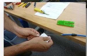
7. Vorbereitetes Kabel in Grundkörperunterteil (gekennzeichnet mit „U“) einlegen und fixieren (evtl. Klammer, Leimzwinge etc. zu Hilfe nehmen). Kabelmantel auf Dorne legen zur Zugentlastung, Bündelröhrchen in den Trichter!
